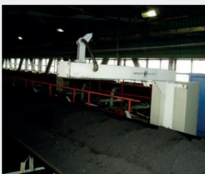
MoistScan® MA-500 instalado en la cinta receptora de carbón de una central eléctrica. El MA-500 se utiliza junto con un analizador elemental en línea para determinar el porcentaje total de cenizas secas y el contenido de azufre del carbón recibido.
