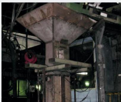
MoistScan® MA-600 instalado en la pared de una tolva que alimenta una prensa briquetadora en una fábrica de briquetas. El material es una mezcla de arena, nitrato de sodio y carbón. El control del contenido de humedad de las briquetas es fundamental. Si la mezcla está demasiado seca las briquetas no se forman correctamente. Si la mezcla está demasiado húmeda, las briquetas pueden partirse en el secador de lecho fluidizado o durante el transporte.
