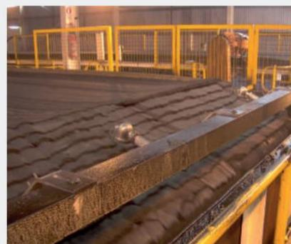
MoistScan® MA-600 instalado en un filtro de correa horizontal en una planta de lavado de carbón. El MA-600 tiene 3 juegos de antenas a lo largo del cinturón. El analizador calcula la humedad promedio en la cinta, que se utiliza para controlar la velocidad de la cinta y la adición de floculante.
