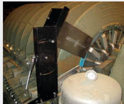
MoistScan® MA-600 instalado en un filtro de disco vertical en una planta procesadora de cobre. El analizador mide la humedad en la torta de filtración. Los datos de MoistScan® controlan la presión de vacío de las placas de filtración para producir una torta de filtración dentro de una estricta especificación de humedad del 7-8%.
