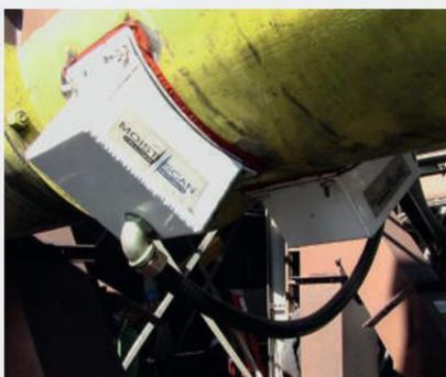
MoistScan® MA-600 instalado en un alimentador de tornillo grande que transporta astillas de madera a una secadora en una planta de carbón vegetal. Los datos de MoistScan® se utilizan para controlar la secadora de manera que las astillas de madera que salen de la secadora tengan entre un 5 y un 12 % de humedad.
