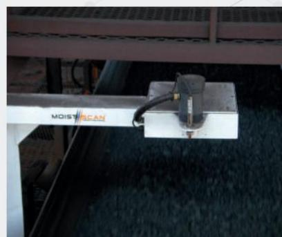
MoistScan® MA-500HDi mide el contenido de humedad de pellets de mineral de hierro en un puerto de envío. El analizador se utiliza para calcular el tonelaje seco total a medida que el producto se carga en el barco.
